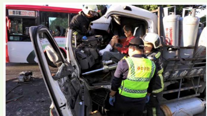
救援畫面-使用油壓推頂桿撐開車室
