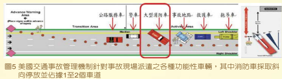
圖5 美國交通事故管理機制針對事故現場派遣之各種功能性車輛，其中消防車採取斜向停放並佔據1至2個車道
