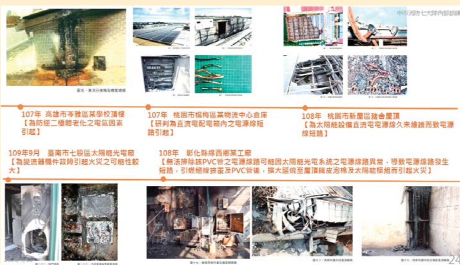
圖3 國內107-109年太陽能發電設備事故資料 (參考內政部消防署網路資料，自行繪製)
