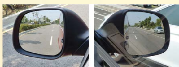
圖4 小型車之兩側主後視鏡及車內後視鏡之建議調整方式，應盡量向外側調整使鏡面靠車輪處僅看到自己車身邊緣即可，另外路面約佔鏡面3分之2，而天空佔鏡面3分之1
