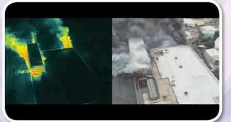
圖3 全聯倉儲熱顯像監控熱源位置
