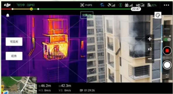
圖片出自DJI先創國際無人機模擬照片，無人機搭載紅外線熱顯像儀，可第一時間勘查現場狀況，有無人員受困、火勢大小、地形格局及火勢延燒狀況等。
